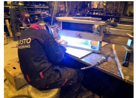
Kuva 10. Esimerkki tuotantotilanteesta, jossa vaativan hitsatun rakenteen käyttäytyminen on simuloitu ennen tuotannon aloittamista. Simulointitulosten perusteella rakenteen hitsaukselle laadittiin tarkka hitsausjärjestys ja rakenteen (ruostumaton teräs 1.4404, 316L) hitsauksesta aiheutuvat muodonmuutokset saatiin pidettyä hyvin koneistusvaiheen vaatimissa toleransseissa.
