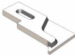
Kuva 5a. Alkuperäinen hitsattu rakenne. Valmistusvaiheina polttoleikkaus, viisteytys, esilämmitys, hitsaus, (NDT), lämpökäsittely, NDT ja koneistus. Hitsit esitetty tummennettuna.
